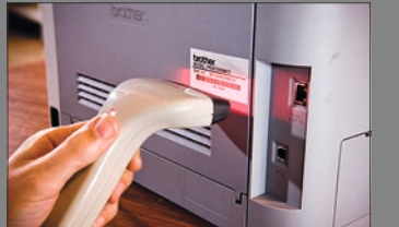
Če želite nalepke tiskati neposredno s tiskalnika nalepk, povežite skener črtnih kod s serijskim vvhodom tiskalnika
